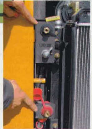
Auf den Baustellen durchaus ein Thema: Bei Case gibt es die Fremdstart-Einrichtung schon ab Werk.
