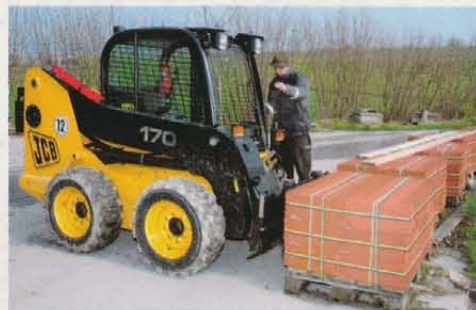
JCB ist der einzige Hersteller von Kompaktladern, der einen einzelnen Hubarm außermittig positioniert.
