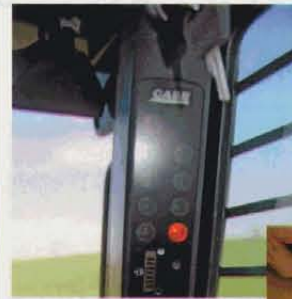
Auf den Baustellen durchaus ein Thema: Bei Case gibt es die Fremdstart-Einrichtung schon ab Werk.
